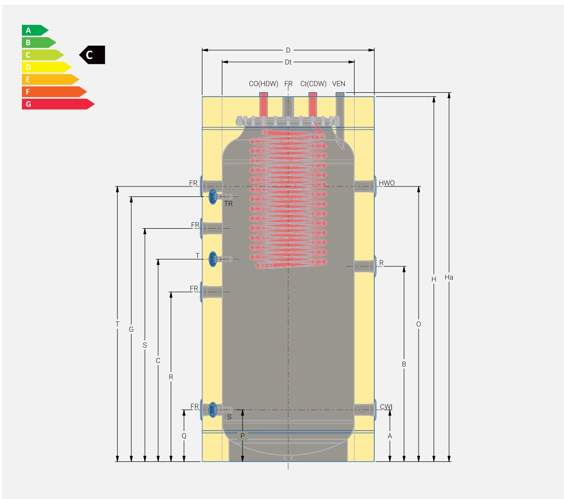
Pour tous les réservoirs, qu'ils soient émaillés ou combinés, il est nécessaire d'installer un vase d'expansion, une soupape de sécurité et une anode de protection pour l'eau chaude sanitaire.
